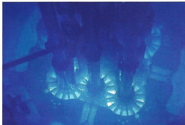
Luce Čerenkov dal caratteristico colore azzurro emessa all'interno del liquido di raffreddamento di un reattore nucleare.
