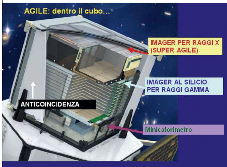
Spaccato dell'interno del satellite AGILE che evidenzia il posizionamento del rivelatore di raggi X (SuperAGILE), del rivelatore al silicio per raggi gamma e del minicalorimetro. Si noti anche l'anticoincidenza, uno schermo di scintillatore plastico che ha il compito di "allertare" il sistema in caso di arrivo di particelle cariche.
