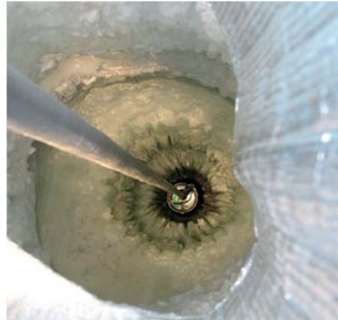
Una stringa di "occhi" di IceCube viene calata nel buco (lungo due chilometri e mezzo) scavato nel ghiaccio con l'acqua bollente.
