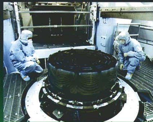
Tecnici della Eastman Kodak controllano l'allineamento degli specchi dell'AXAF. (foto Kodak)
